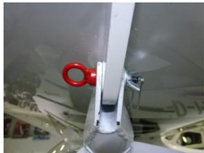
Dabei kann die Strebe zunächst am Rumpf verbunden bleiben. Dann kann der obere Strebenbolzen entfernt werden, dabei muss der Flügel am Randbogen in Position gehalten werden.
