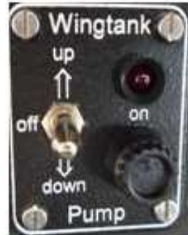
Sobald der Zusatztank befüllt ist, öffnet sich dessen Überdruckventil, der überfließende Kraftstoff läuft dabei erkennbar in das Entlüftungssystem des Haupttanks zurück (23 ist an 8/9 angeschlossen). Jetzt wird die Förderpumpe abgestellt und der Absperrhahn geschlossen.
