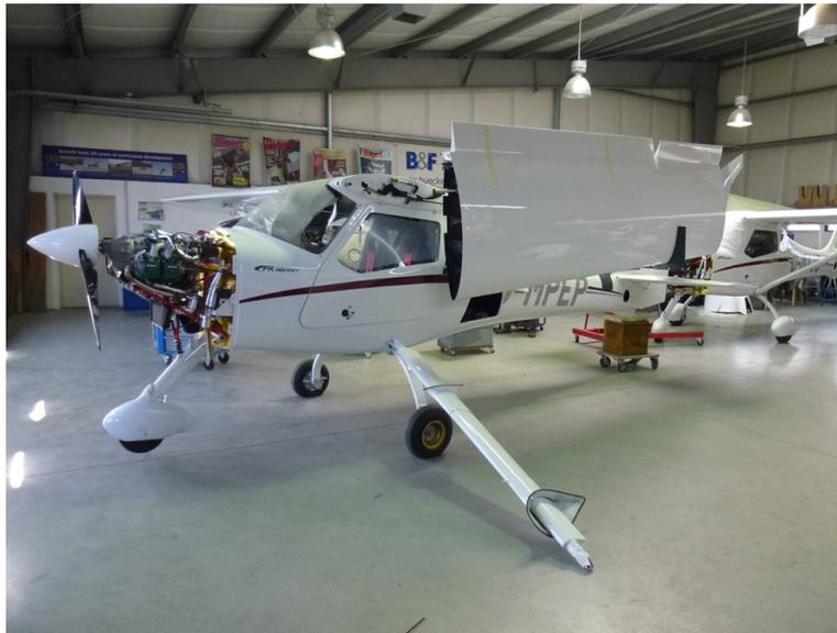
Nach erfolgtem Beiklappen der Flügel können die rumpfseitigen Verbindungen der Streben abgenommen werden.
